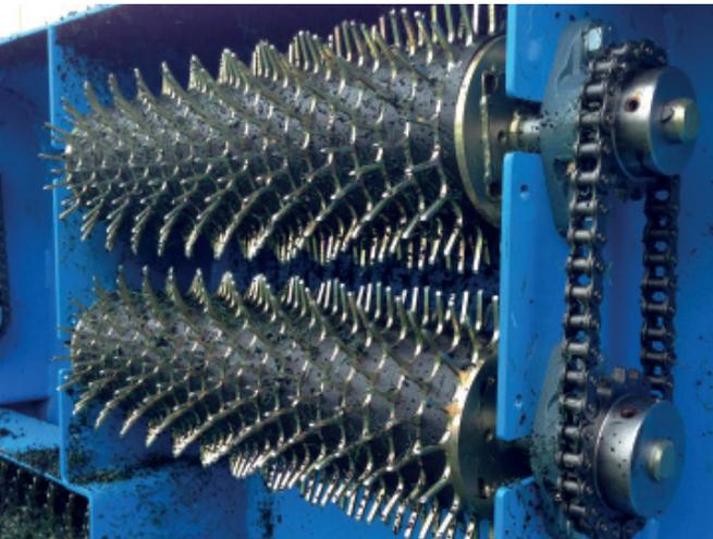
AERATION AND DE-COMPACTION OF THE FIELD IS ACHIEVED BY USING MATCHED PAIRS OF SPIKE ROLLERS. THE GEAR RATIO BETWEEN THE ROLLERS RESULTS IN A LEVERING EFFECT THAT FORCES THE INFILL MATERIAL TO THE SURFACE.
