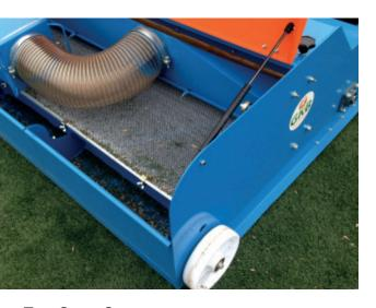
THE QUICK-CLEAN CAN BE USED ON ALL TYPES OF ARTIFICIAL TURF. THE SIEVE PLATES ARE EASILY INTERCHANGEABLE FOR DIFFERENT GRAIN SIZES (SAND / RUBBER / TPE / CORK).
