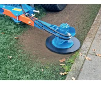
THE ROTOBRUSH IS SPECIALLY DESIGNED TO BRUSH THE EDGES OF ARTIFICIAL GRASS, WHERE MOSS AND THE GROWTH OF ALGAE ARE A WELL-KNOWN PROBLEM.
