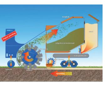
THREE HEIGHT-ADJUSTABLE LOAD-BEARING ROLLERS ALLOW FOR THE MACHINE TO FOLLOW THE CONTOURS OF THE SURFACE. THE (COMBI-) ROTOR CAN BE FOUND BETWEEN THESE ROLLERS, AND CAN BE USED TO SCARIFY AND FRASE MOW.
